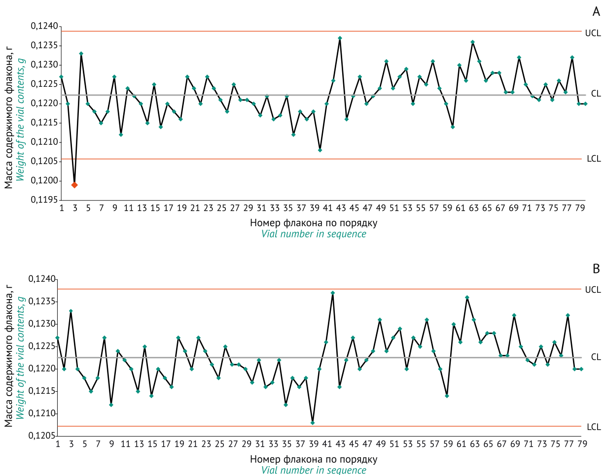
Рис. 4. X-карты, построенные по значениям массы модельного образца первой серии после лиофилизации: А – все данные по серии образцов; В – контрольная карта после удаления образцов, выходящих за контрольные границы. UCL и LCL – верхняя и нижняя контрольные границы; CL – центральная линия.
