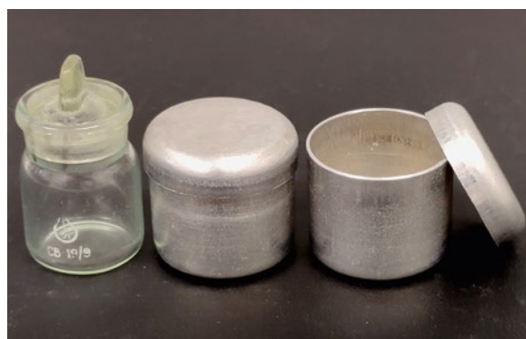
Рис. 2. Стеклянный и алюминиевые бюксы для проведения испытаний по показателю «Потеря в массе при высушивании».
