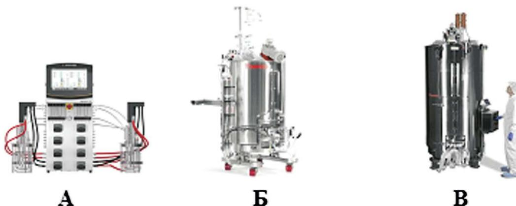
**Рис. 2.** Биореакторы, применяемые для культивирования продуцента дорназы альфа: А — Biostat B (Sartorius) объемом 2 л; Б — Hyclone SUB100 объемом 100 л; В — Hyclone SUB1000 объемом 1000 л.
