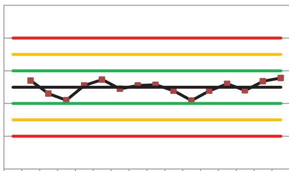
Критерий 7 (15 последовательных точек в зоне C ( \pm 1\sigma ), выше и ниже центральной линии)
