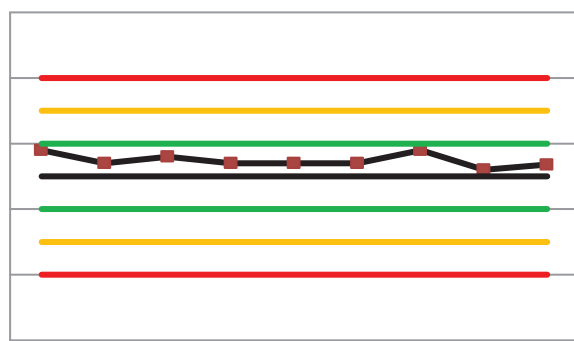
Критерий 2 (9 точек подряд в зоне C ( \pm 1\sigma ) или по одну сторону от центральной линии)
