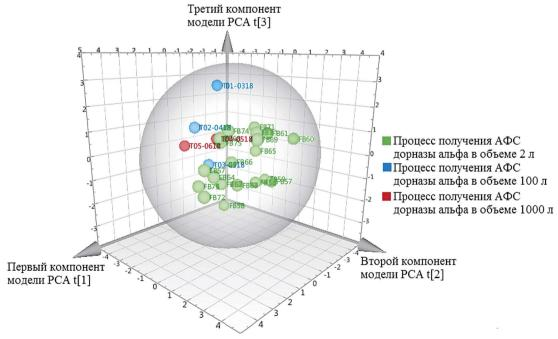
Рис. 4. 95 % доверительный эллипсоид модели РСА, построенный с использованием данных процессов в объеме 2 л (20 процессов), 100 л (3 процесса), 1000 л (2 процесса).
