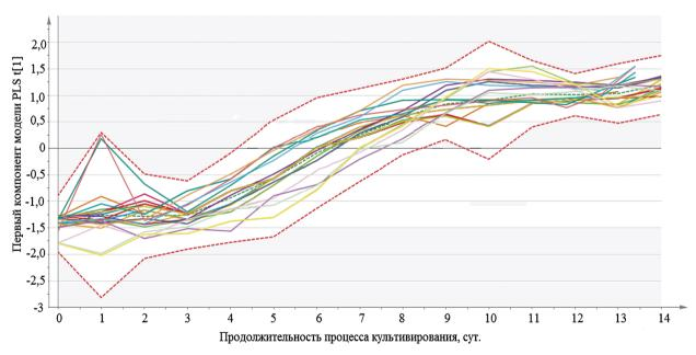
Рис. 5. Контрольная диаграмма траектории первого основного компонента статистической модели PLS t [1] (---), его допустимого диапазона (среднее значение  $\pm$  3 ст. откл. (---)) и траектории двадцати процессов в объеме 2 л, трех процессов в 100 л, двух процессов в 1000 л.
